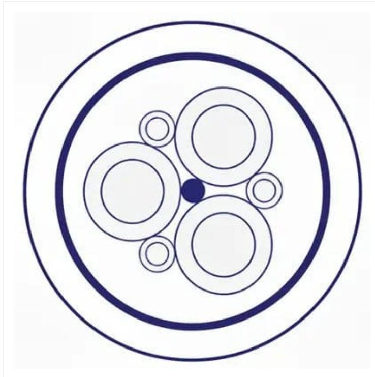
Cabo de Potência e Controle, Uso Móvel; 0,6/1 kV; 1 a 12 condutores; max. 70,0mm<sup>2</sup>, Veias Numeradas; LSZH, CECO™ / CECO™ / CEAC™, Resistência a chama e Óleos; -50°C/+80°C
