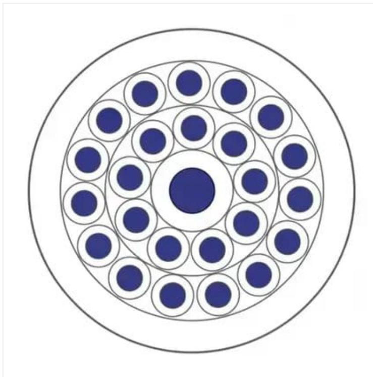
Cabo de Potência e Controle, Uso Móvel; 300/500V; 6 a 42 condutores; max. 1,00mm<sup>2</sup>, Veias Numeradas; PVC / PVC, Resistência a chama; -40°C/+55°C
