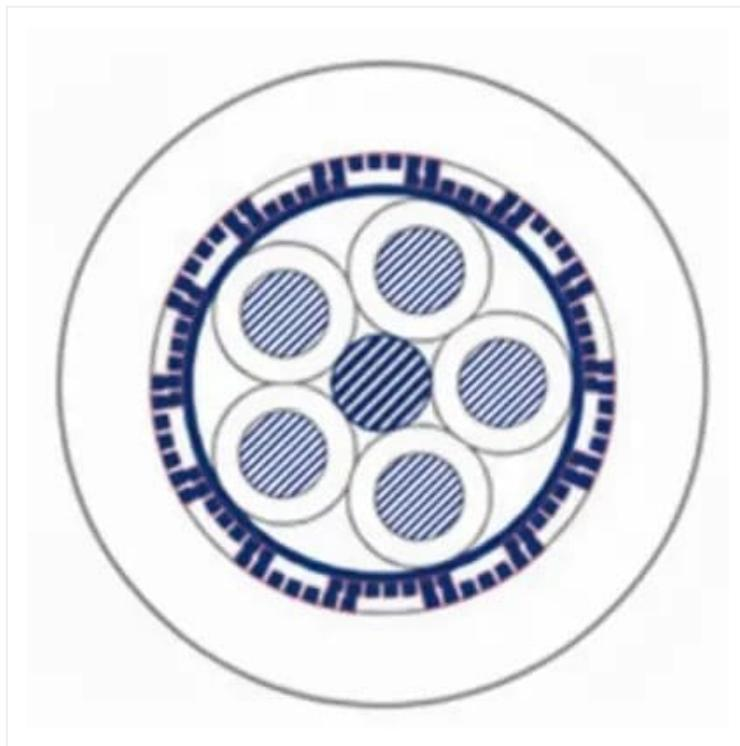
Cabo de Potência e Controle; 300/500V; 2 a 41 condutores; max. 1,50mm<sup>2</sup>; PVC / PVC,
