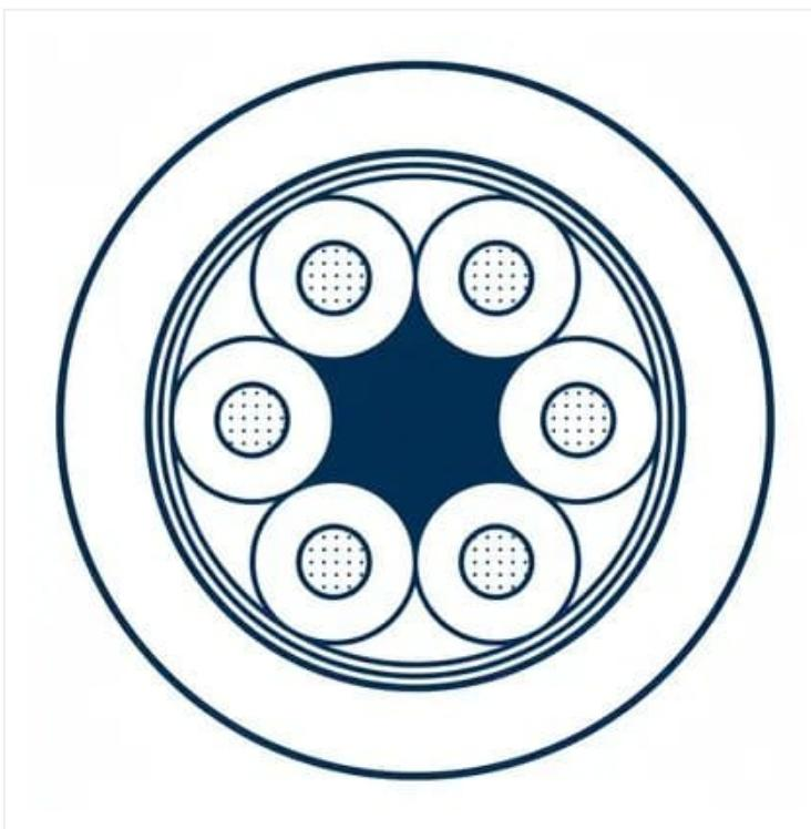
Cabo Flexivel de Potência; Uso fixo; Max. 500,00mm<sup>2</sup>; 0,6/1 kV; 1 a 4 condutores;
