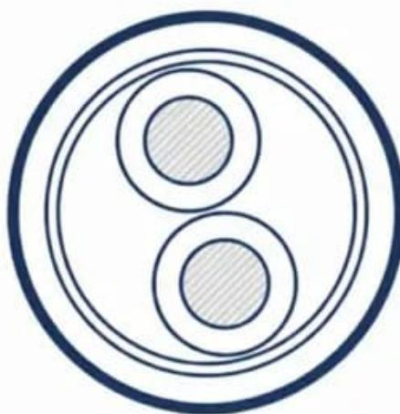
Cabo de Instrumentação e Controle para Incêndio ; 600 V; 1 par; max. 1,50mm<sup>2</sup>; PVC / PVC, Antichama; +70°C
