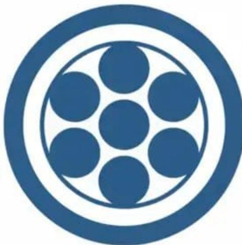
Cabo de Potência; 0,6/1 kV; 1 a 4 condutores; max. 185,00mm<sup>2</sup>; MICA / XLPE / LSZH,
