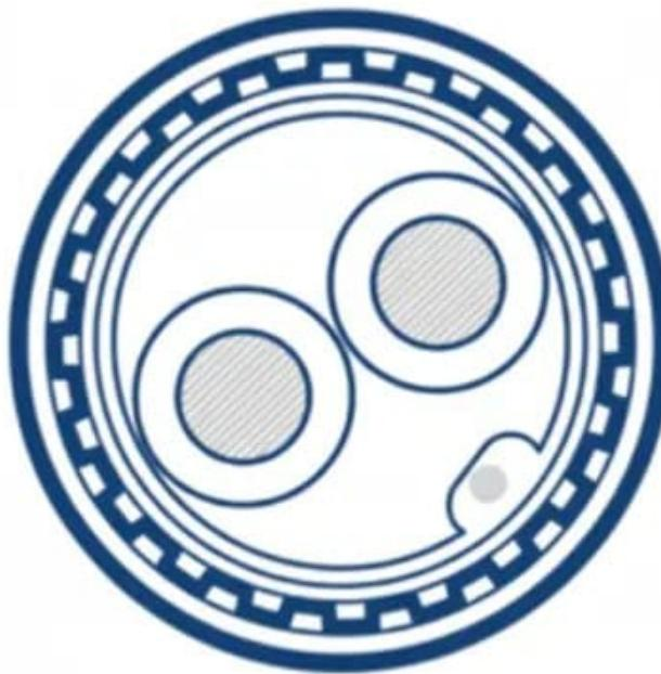
Cabo de Instrumentação e Controle para Incêndio; Blindado ; 600 V; 1 par; max. 2,50mm<sup>2</sup>; PVC / PVC, Antichama; +70°C
