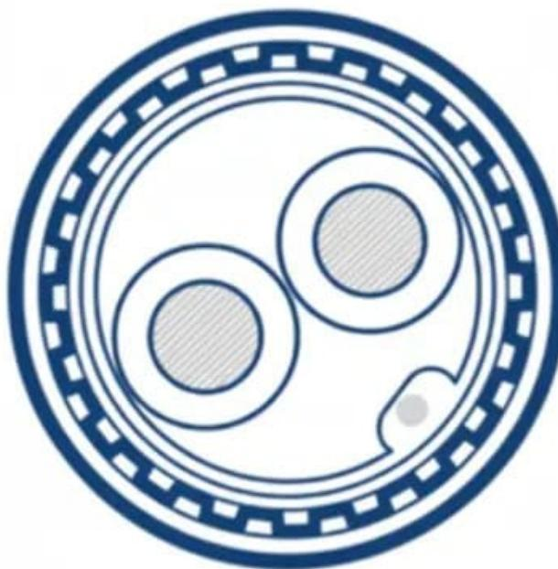
Cabo de Instrumentação e Controle para Incêndio; Blindado ; 300 V; 1 par ou trio; max. 2,50mm<sup>2</sup>; PVC / PVC, Antichama; +70°C
