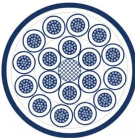
Cabo de Potência e Controle; Max. 10,00mm<sup>2</sup>; Até 1,0mm<sup>2</sup> 500V; De 1,50mm<sup>2</sup> a 10,00mm<sup>2</sup> 1000V; 2 a 56 condutores; Veias Numeradas; HEPR / SHF1; Antichama; +70°C
