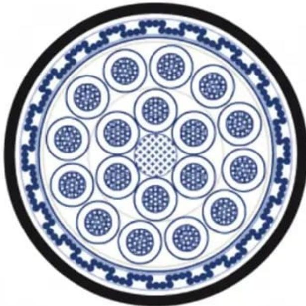
Cabo de Potência e Controle; 300/500V ; 2 a 50 condutores; max. 95,00mm<sup>2</sup>; PVC / PVC, Resistência a chama e óleos; +80°C
