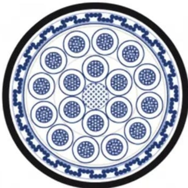
Cabo de Potência e Controle; 300/500V ; 2 a 50 condutores; max. 50,00mm<sup>2</sup>; PVC / PVC, Resistência a chama e óleos; +80°C
