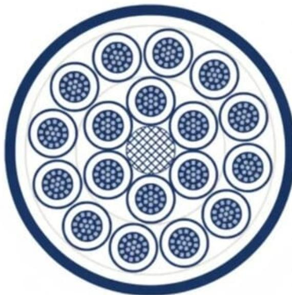
Cabo de Potência e Controle; 0,6/1 kV; 2 a 25 condutores; max. 95,00mm<sup>2</sup>; PVC / PVC, Resistência a chama e óleos; +80°C
