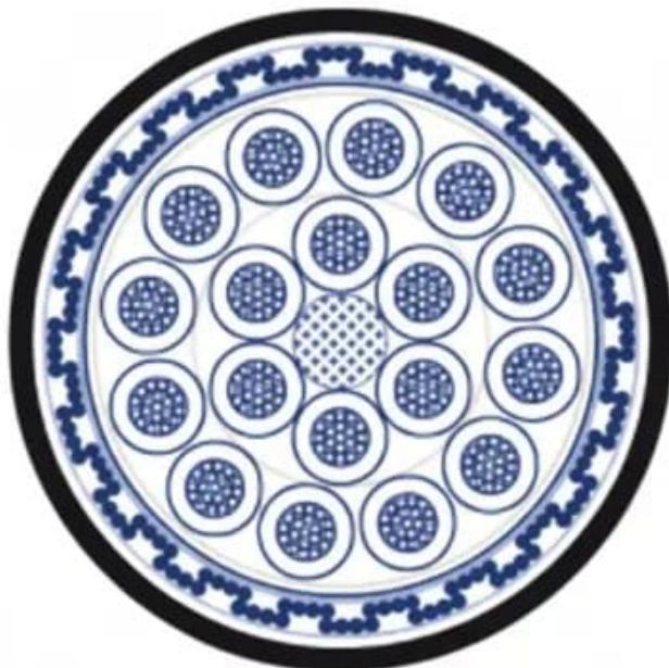
Cabo de Potência e Controle; 500V a 0,6/1 kV; 2 a 50 condutores; max. 95,00mm<sup>2</sup>;
