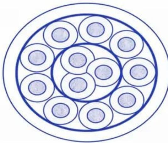
Cabo de Potência e Controle; 500V a 0,6/1 kV; 2 a 12 condutores; max. 120,00mm<sup>2</sup>; PVC / PVC, Resistência a chama e Óleos; +80°C
