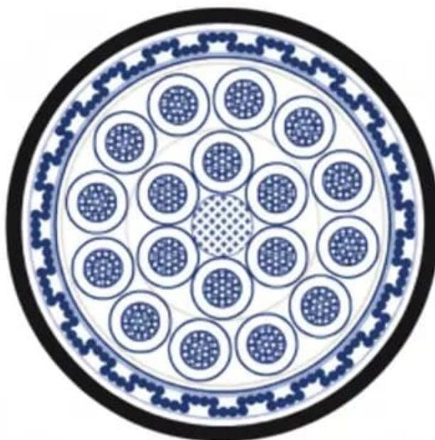
Cabo de Potência e Controle; 0,6/1 kV; 2 a 61 condutores; max. 4,00mm<sup>2</sup>; LSZH; HEPR / PUR-AC, Resistência a chama e óleos; +90°C
