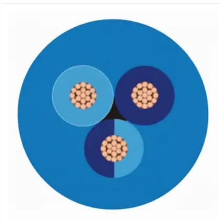
Cabo de Potência e Controle; 450/750 V; 2 a 5 condutores; Max. 16,00mm<sup>2</sup>; Veias Numeradas, CECO™/PUR, Resistência a Óleos; -40°C/+90°C
