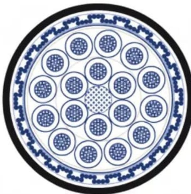
Cabo de Potência e Controle; 300/500 V; 2 a 25 condutores; max. 25,00mm<sup>2</sup>; LSZH;
