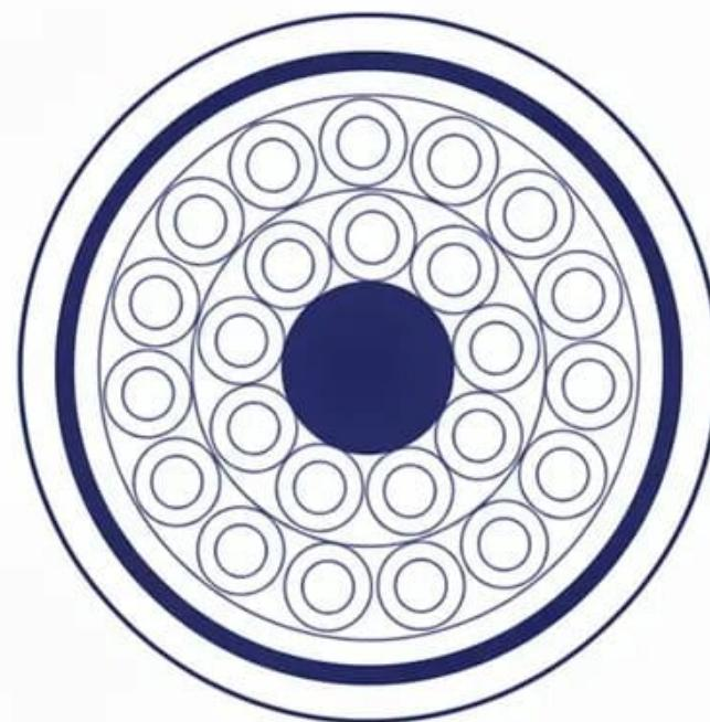
Cabo de Potência e Controle; Blindado em Fita de Cobre; Max. 10,00mm<sup>2</sup>; Até 1,0mm<sup>2</sup>
