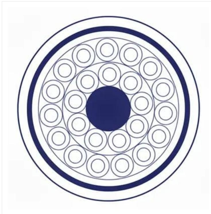
Cabo de Potência e Controle; Blindado em Fita de Cobre; Max. 10,00mm<sup>2</sup>; Até 1,0mm<sup>2</sup> 500V; De 1,50mm<sup>2</sup> a 10,00mm<sup>2</sup> 1000V; 2 a 56 condutores; Veias Numeradas; PVC / PVC; Antichama; +70°C
