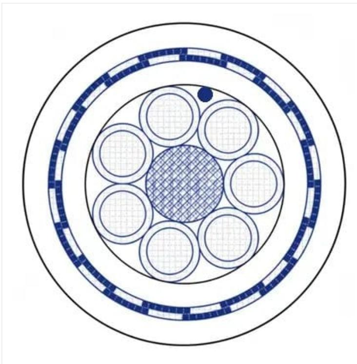
Cabo de Potência e Controle; Blindado em Fita + Trança de Aço; Max. 10,00mm<sup>2</sup>; Até 1,0mm<sup>2</sup> 500V; De 1,50mm<sup>2</sup> a 10,00mm<sup>2</sup> 1000V; 2 a 56 condutores; Veias Numeradas; PVC / PVC / PVC; Antichama; +70°C
