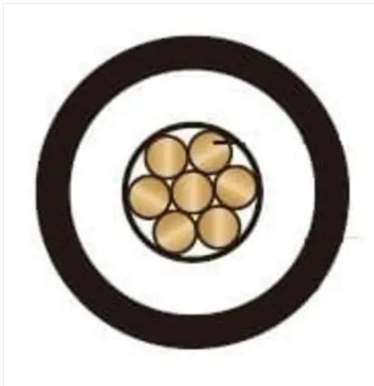
Cabo de potência para balizamento em aeroportos; 5 kV; 1 condutor; 4 AWG; (XLPE) ou EPR-B / PE ou PVC; 90°C
