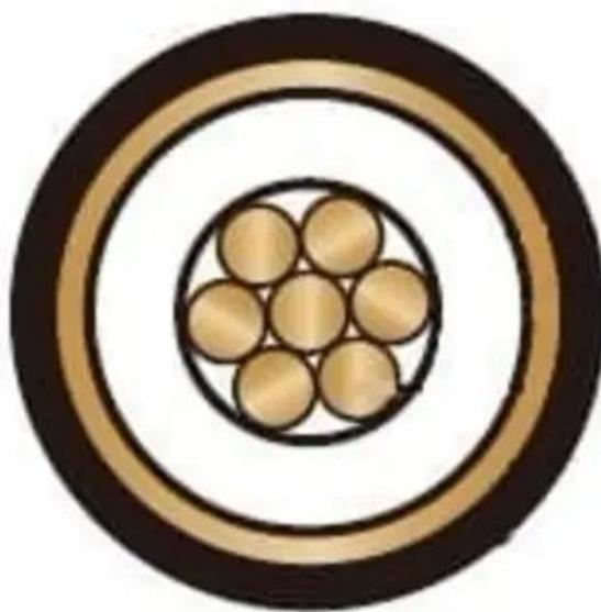
Cabo de potência para balizamento em aeroportos; Blindado; 5 kV; 1 condutor; 8 AWG / 6,00mm<sup>2</sup>; EPR / CPE; 85°C
