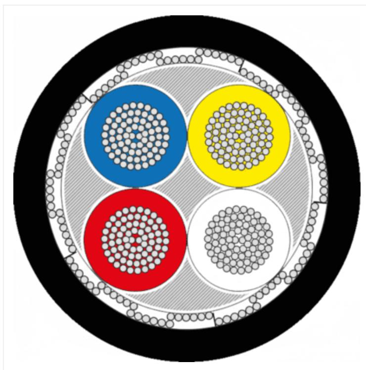
Cabo de Automação; AFT; Uso fixo; 132 Ω/km (26 AWG) até 13 Ω/km (16 AWG); PE/PVC; 150V a 300V rms; Preto
