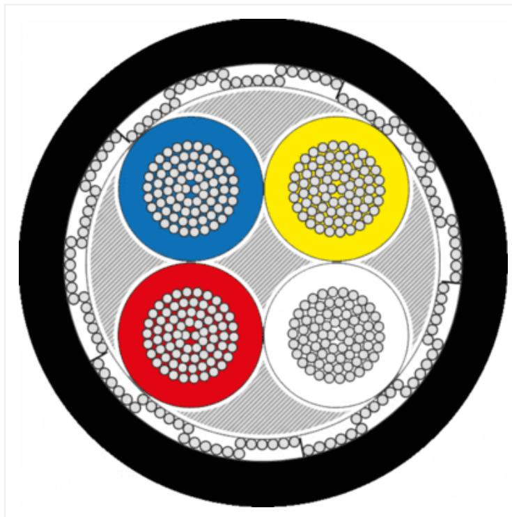
Cabo de Automação; AFS; Uso fixo; De 24 a 91 Ω/km (conforme bitola AWG); PE/PVC; 150V a 300V rms; Preto
